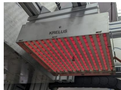
Infrarot-Strahler, der für die Durchführung der Trocknungsversuche verwendet werden soll.
