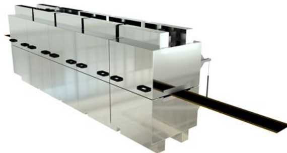
Abbildung: Selbstentwickelter Konvektivtrockner für Batterieelektroden
