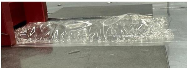
Abb. 1: Quellverhalten einer Membran nach Auftrag eines Lösemittelgemisches.
